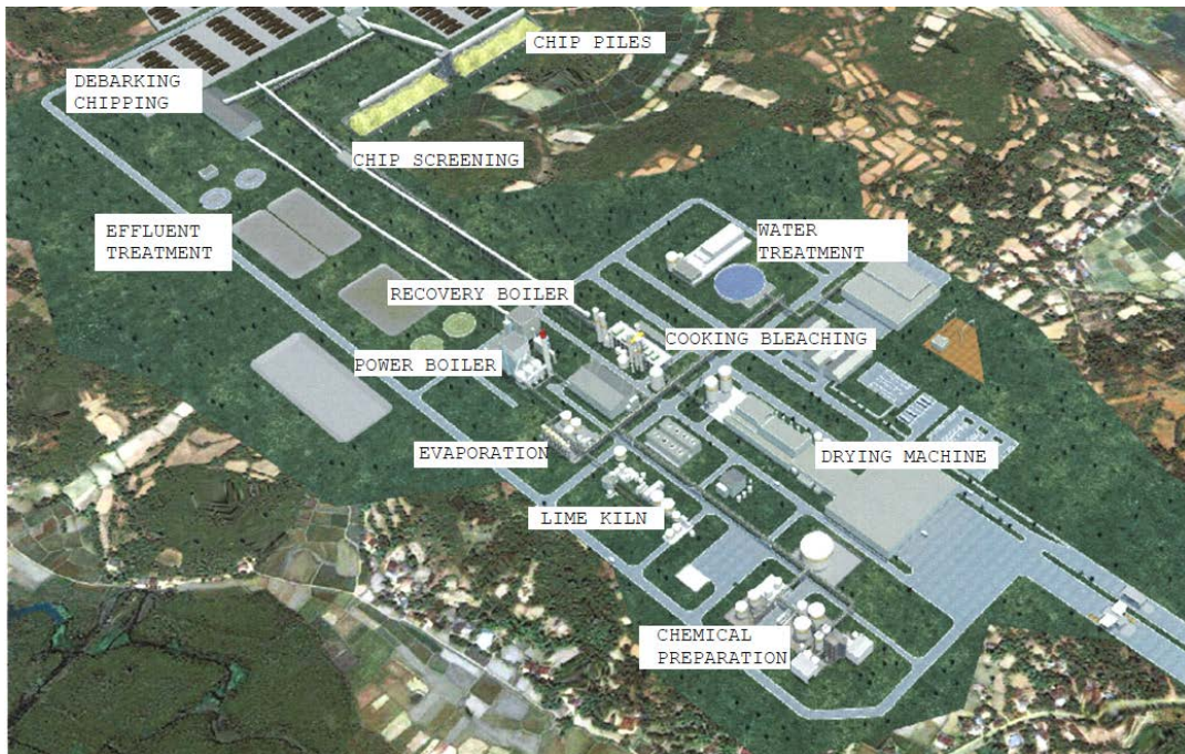
Kuva 3. Tyypillinen tehdasasettelu. (Lähde: Pöyry)
